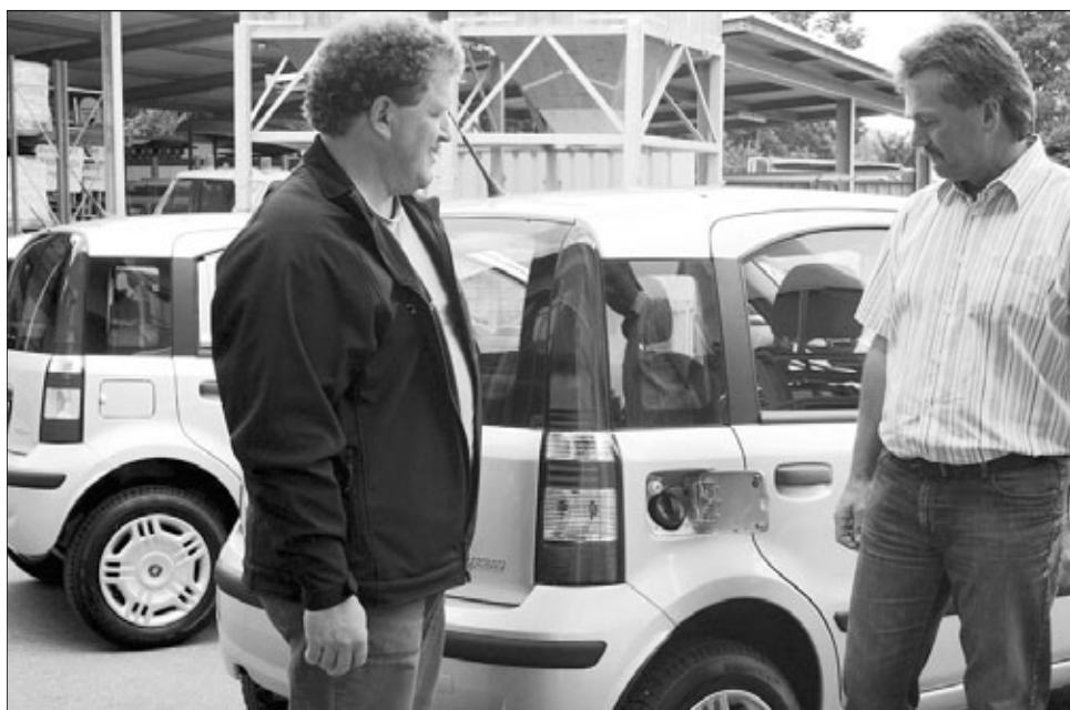
Insgesamt drei mit Erdgas betriebene „Fiat Panda“ ergänzen den städtischen Fuhrpark, der insgesamt 16 auf eine Gasart abgestimmte Fahrzeuge unterhält. Der Blick hinter die Kraftstoffklappe macht deutlich: Ein kleines „Zapfloch“ für das Erdgas, ein herkömmliches für das „Notbenzin“, falls keine Gastankstelle erreichbar ist, wie der Leiter des städtischen Betriebshofs, Achim Wieler, rechts, und Kfz-Meister Ronald Schmidt erklärt haben. Foto: Greiner
